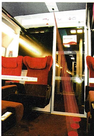
Der neue Sensor im Türbereich des Thalys Foto: Thalys
